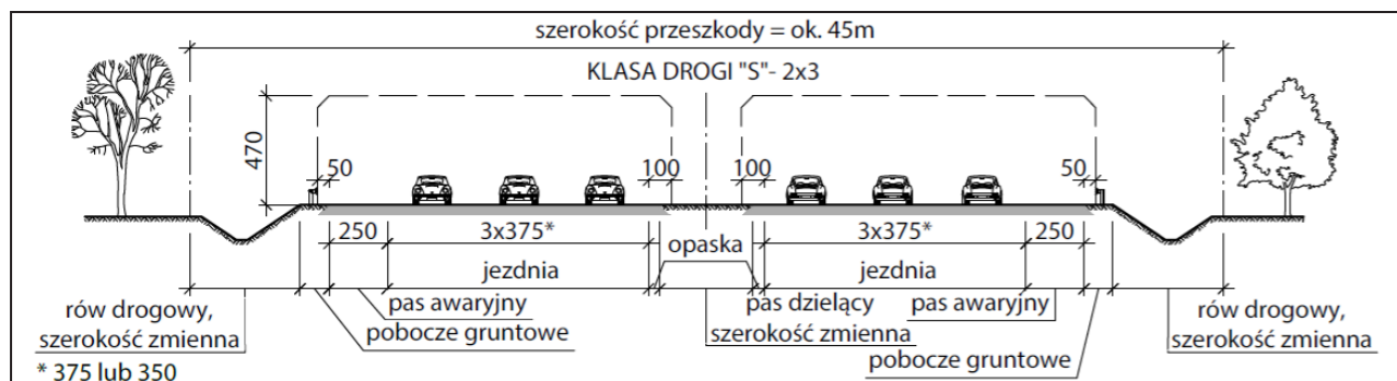
Rys. 3-5. Droga klasy „S” o przekroju 2 x 3
