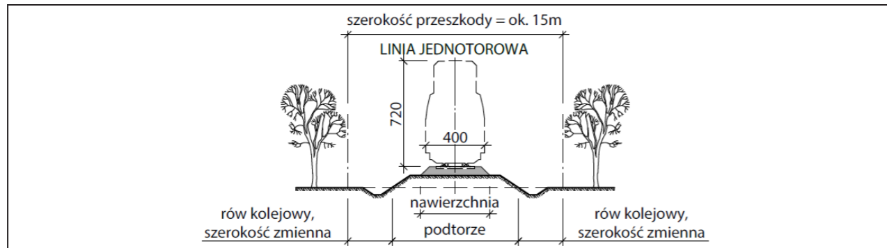
Rys. 3-13. Linia magistralna jednotorowa
