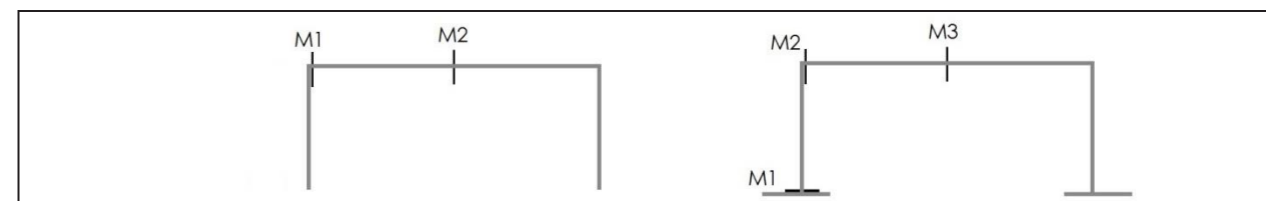
Rys. Z1-5. Oznaczenia momentów zginających dla przepustów dwuczściowych i małych mostów
